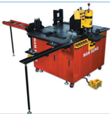
BUSBAR PROCESSING MACHINE MÁY GIA CÔNG ĐỒNG THANH CẢI
